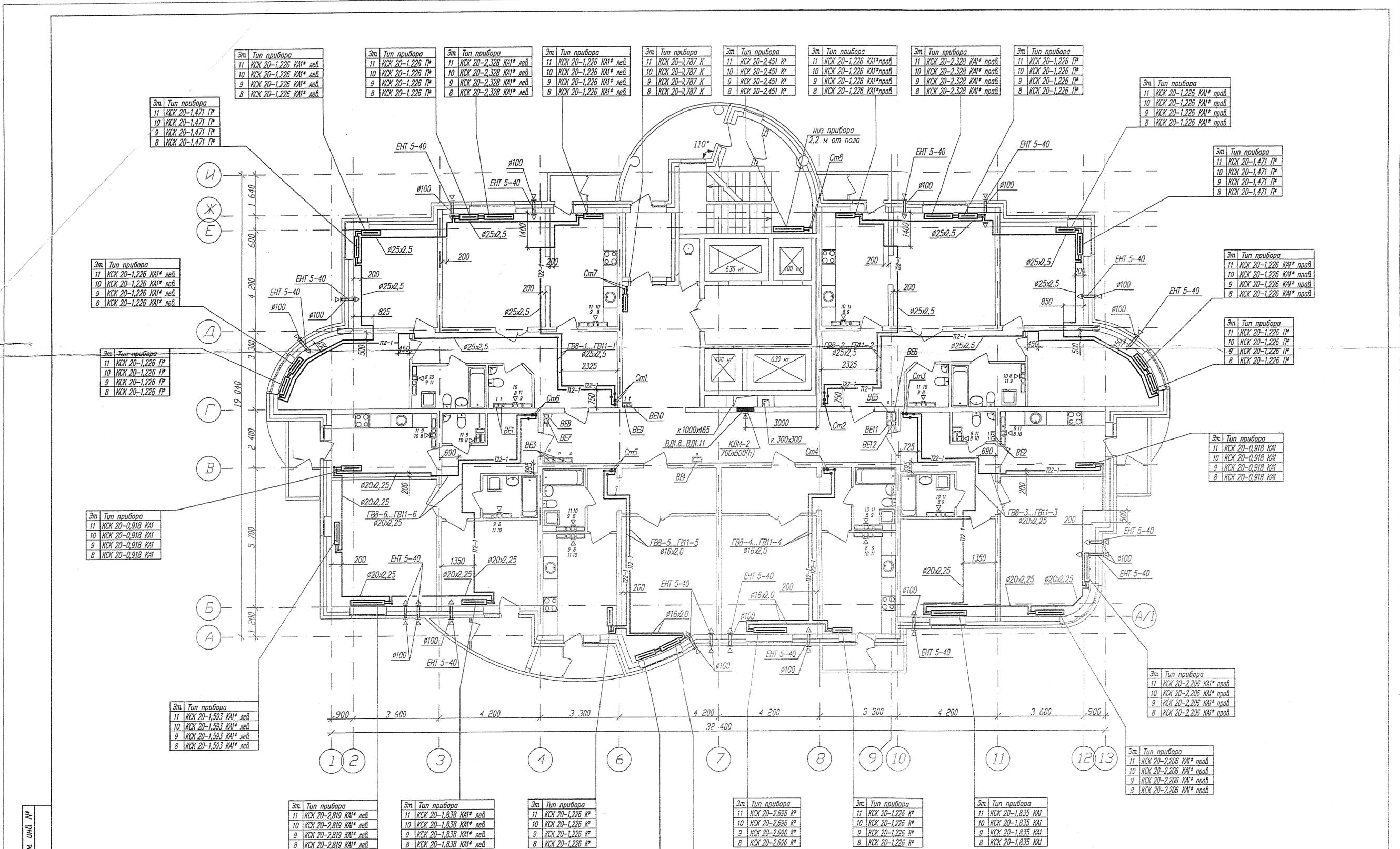
Указанные на чертеже типы вытяжных решеток принять ВР 120x200(н).
